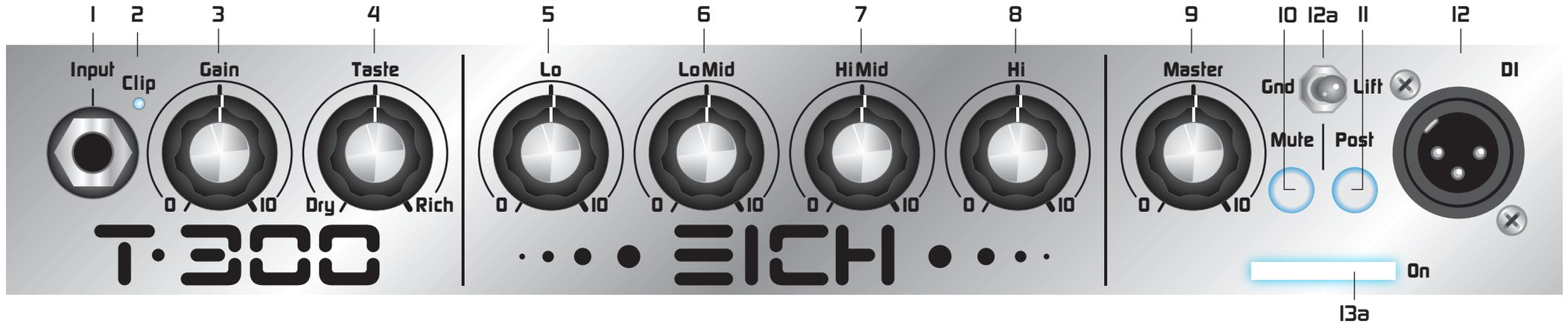
drückt sein (Schalter leuchtet). In dieser Stellung wird das Instrumentensignal nicht an die Ausgänge weiter geleitet. Allerdings gelangt das Instrumentensignal weiterhin an die »TUNER«-Buchse (#21), so dass geräuschlos gestimmt werden kann. Sie müssen dafür nicht extra den Lautstärkeregler herunter drehen. Auch bei einem Instrumentenwechsel bietet sich dieser Schalter an, weil dann lästige Kontaktgeräusche vom Klinkenstecker unterbunden werden.
